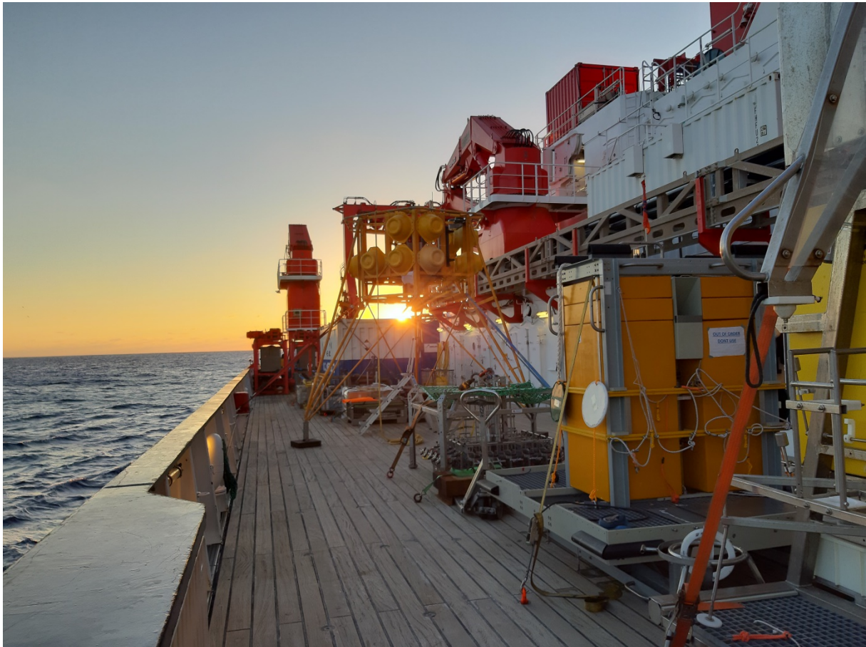
Photo (Steffen Niemann): Benthische Landersysteme und Multicorer auf dem Arbeitsdeck von FS SONNE.
