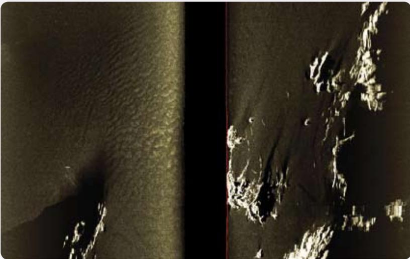
*Abb. 5: Typisches Sonarbild des Meeresboden, wie es während der Suche aufgenommen wurde. Deutlich erkennt man einzelnen Rippelmarken in dem dunklen Sediment links sowie die helle Rückstreuung der harten Gesteine. Die Pixelgröße in diesem Bild nimmt vom Zentrum nach aussen zu. In der Bildmitte beträgt die Auflösung etwa 50 cm.*
