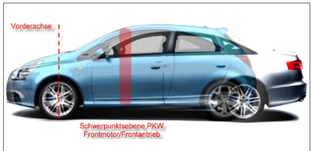
Abb.2 Schwerpunktebene frontgetriebener Fahrzeuge
