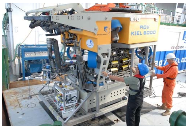
Ausbringen des ROV beladen mit einer benthischen Kammer und dem neuen Eddy Correlation System. Foto: Peter Linke, IFM-GEOMAR.
