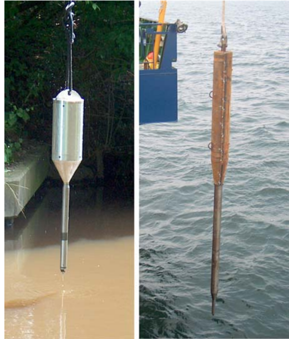
Abb. 5: FF-CPT-Lanzen zur in situ-Messung von Scherfestigkeit, Porendruck und Temperatur. Beides sind Eigenentwicklungen der Univ. Bremen, links Flach-, rechts Tiefwassergerät.
