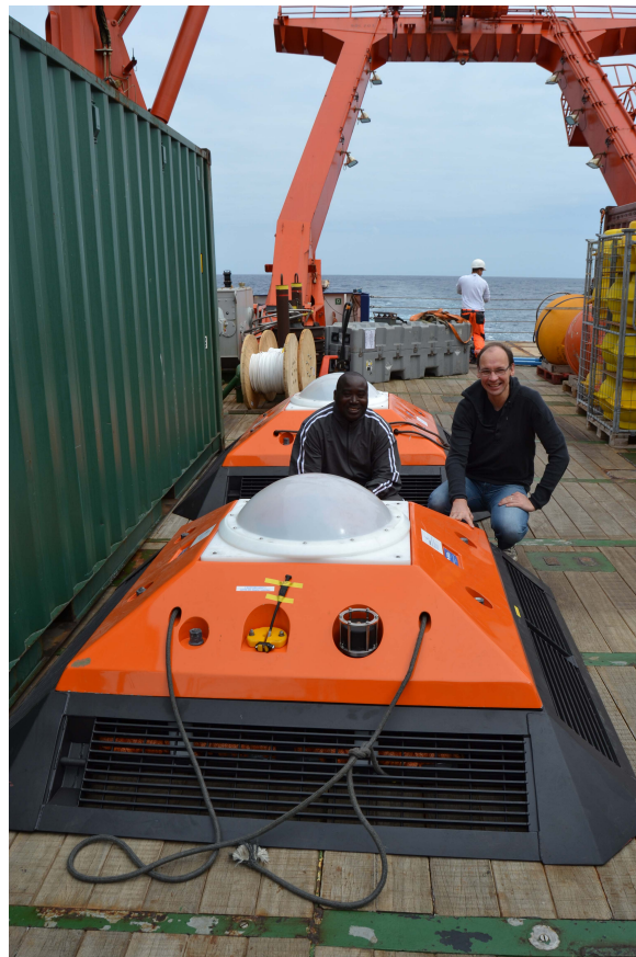
Fig. 1: Duas armações de fundo equipadas com correntômetros (ADCPs) a bordo do Meteor para serem colocadas na plataforma costeira angolana. Os instrumentos foram colocados nas profundidades de 200 m e 500 m e medirá o fluxo na parte superior do oceano até a sua recuperação em 1.5 anos.
