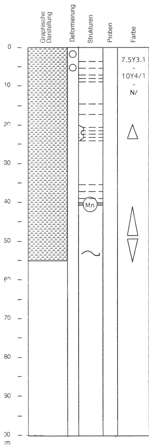
SCHLICK, schwarzgrauoliv bis schwarz, grau, mit Monosulfid imprägniert und mit einzelnen Mn-Carbonatlagen (40-41 cm). Teilweise undeutlich gebändert und bioturbiert. Einige Intervalle mit Farbgradierung von hell bis dunkel oder umgekehrt. Die ersten 4 cm sehr wasserreich und suppig.
