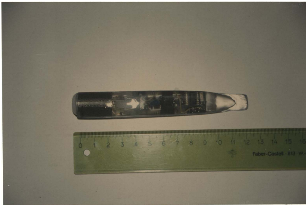
Abbildung 8: Datenspeicher mit Geschwindigkeitssensor
