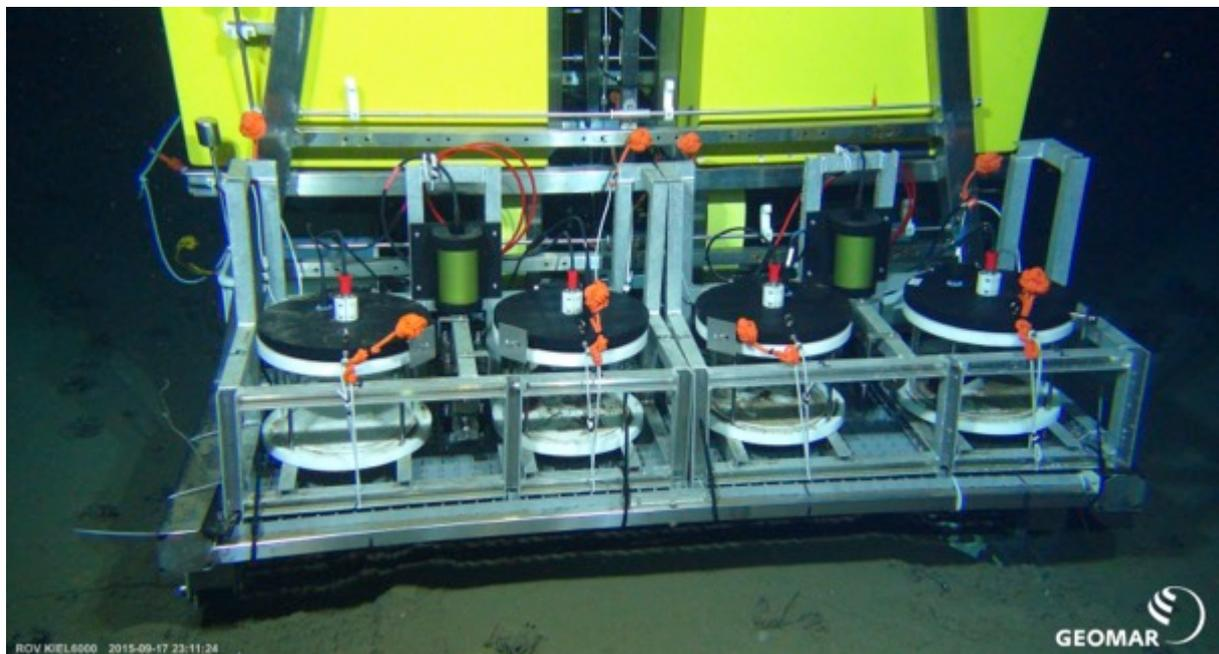
So gab es letzte Woche jeden Tag einen Tauchgang – um 04:00 morgens wurden die Inkubatoren mittels Tiefseefahrstuhl am Meeresboden abgesetzt (Abb. 1), von 8.30 bis 20:00 wurde getaucht, nachts wurden andere Geräte eingesetzt wie Wasserschöpfer, Multicorer, OFOS-Schlitten, und die Freifall-Kammern messen nebenher parallel zu den Schiffstationen. Nur am Samstag stand der Roboter einmal still, weil wir die Zeit für die
