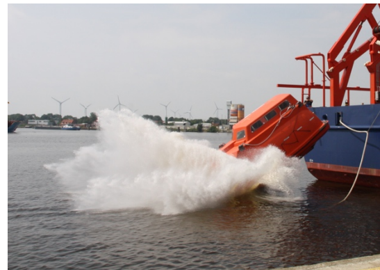
Test des Freifall-Rettungsboots, Photo: Christiane Lösel
