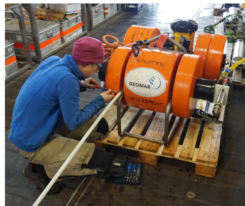
W. Martens bei Arbeiten am Bodenlander im Hangar der Merian (Foto: J. Karstensen)
