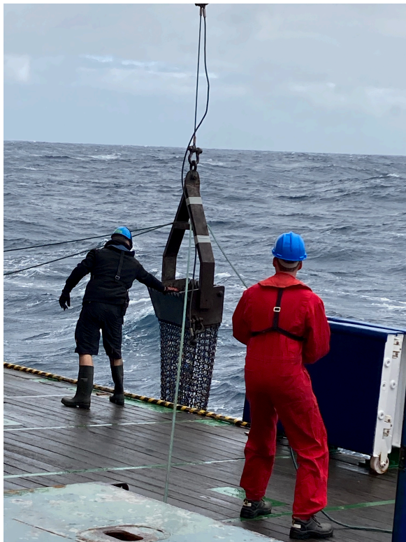
Abb. 1: Aussetzen einer Kettensackdredge bei bewegter See. Decksmannschaft (in schwarz) und Wissenschaft (rot) arbeiten Hand in Hand. Foto: J.G.
