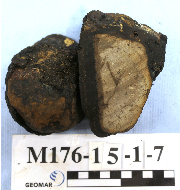
Abb.3: Aufgesägte Gesteinsprobe aus hellgrauem Basalt, der nahezu vollständig von einer 1-2 cm dicken, schwarzen Mn-Kruste überzogen ist. Solche Krusten wachsen unglaublich langsam (1-5 mm in einer Million Jahren) durch chemische Ausfällungen von gelöstem Mangan und anderen Metallen direkt aus dem Meerwasser. Geborgen aus über 3000 m Tiefe von einem Seamount bei 45°26'N/14°21'W. Foto: H.R.
