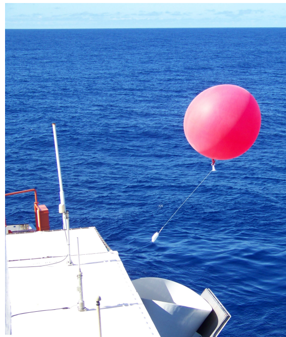
Abb. 2: Start des Wetterballons mit der Messsonde (kleine weiße Box) von Bord der METEOR. Foto: A. Raeke (DWD)
