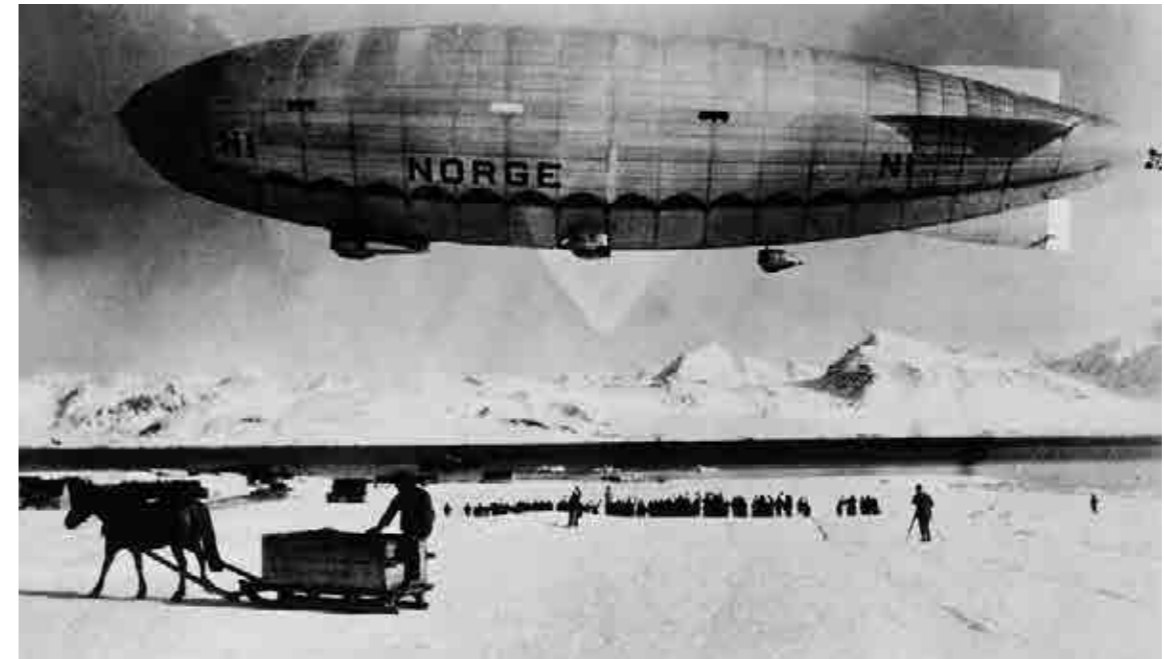
1.30 > Das Luftschiff „Norge“, mit dem Roald Amundsen und sein Gefolge im Mai 1926 von Spitzbergen aus den Nordpol überflogen. Es war 109 Meter lang und erreichte eine Höchstgeschwindigkeit von 85 Kilometern pro Stunde.
