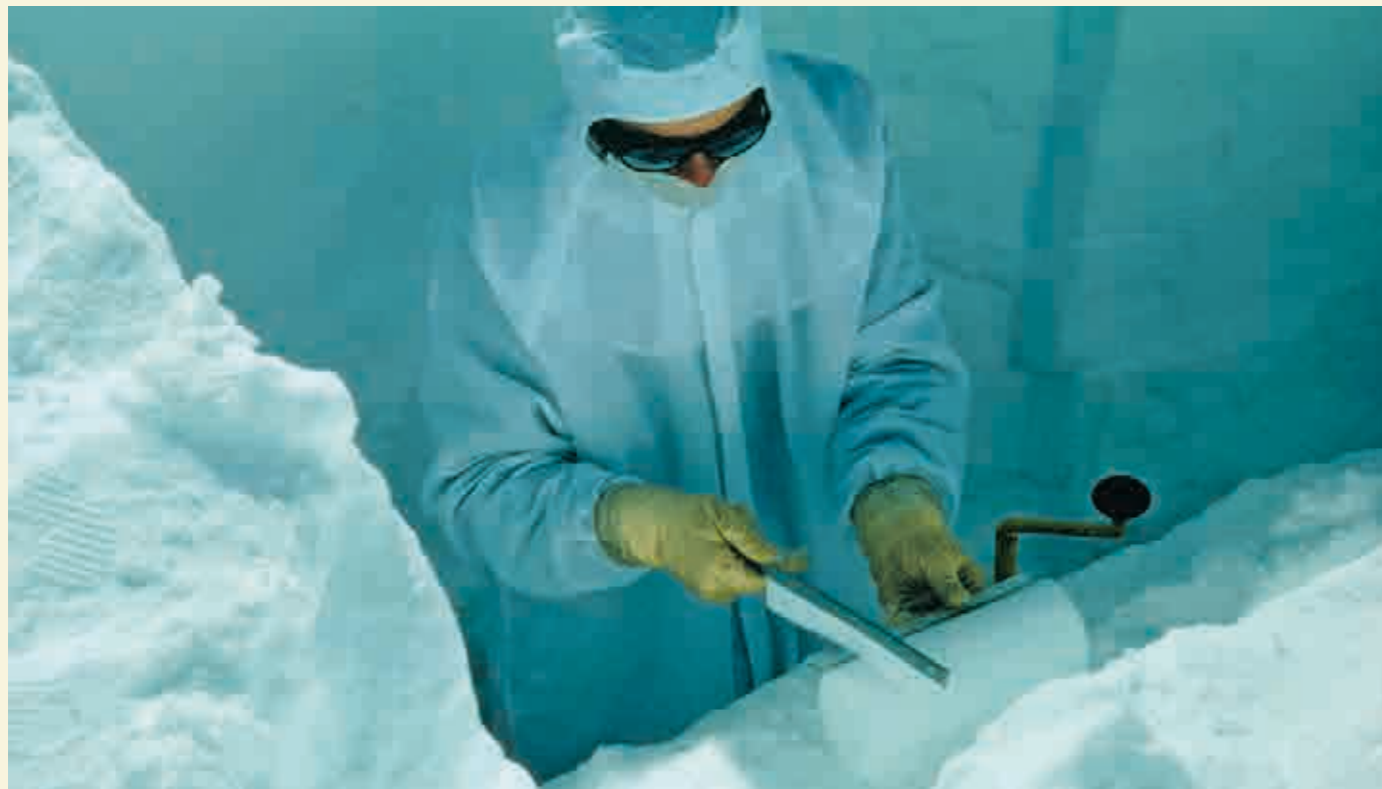
3.13 > Ein Forscher zersägt einen frisch gebohrten Eiskern. Dabei trägt der Wissenschaftler Schutzkleidung, um die Eisprobe nicht zu verunreinigen. Die Untersuchungsdaten geben wichtige Aufschlüsse über Klimaänderungen in der Vergangenheit.
