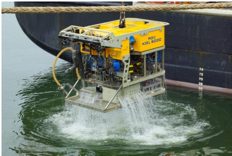
Abb. 3: Testtauchgang des ferngesteuerten Tiefseeroboters ROV Kiel 6000 im Hafen von Guayaquil (CONTECTON-Terminal, Liegeplatz 6). Das ROV wird auf der Reise SO288 zur Bergung des GeoSEA Arrays eingesetzt.
