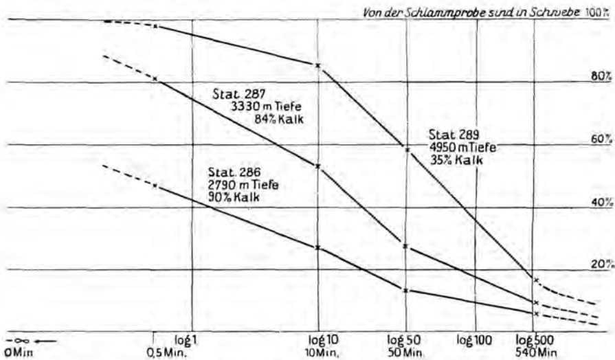
Abb. 42. Beziehung zwischen Korngröße, Tiefe und Kalkgehalt.
