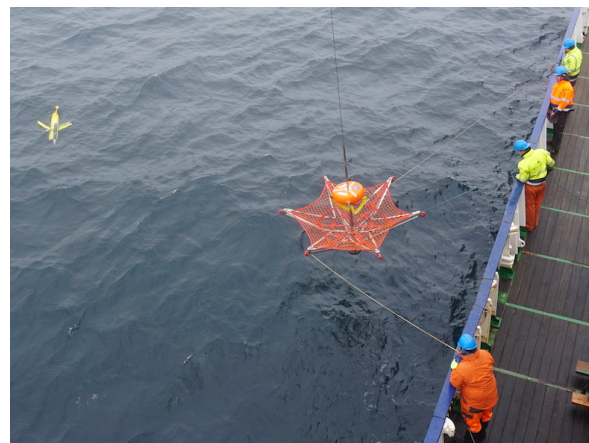
Bergung eines Unterwasser-Gleiters (links am Bildrand) mit Hilfe eines Rettungsschirms. Foto: J. Karstensen
