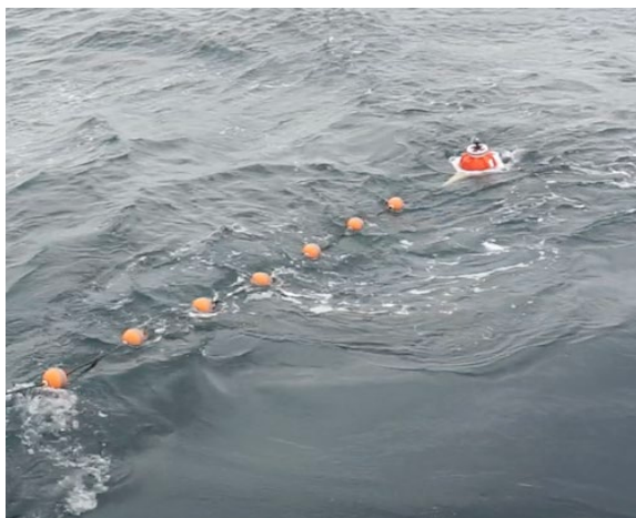
Das Oberflächentelemetrie Modul der K1 Verankerung bei der Auslegung hinter der FS Meteor. Foto: J. Karstensen
