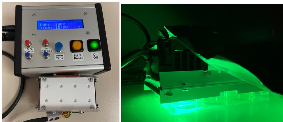
**Abb. A.3.:** **Links:** Foto der beschriebenen Lampe. Mit Hilfe des Steuermoduls konnten die Intensität und die Bestrahlungsdauer genau gesteuert werden. **Rechts:** Abgebildet ist die Lampe auf ihrem Metallgestell, welches für die Bestrahlung von Mikrotiterplatten verwendet wurde.
