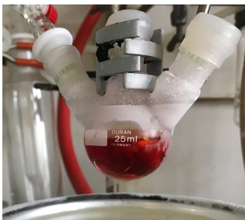
**Abb. 4.18.:** Nach Zugabe von LDA zu **74** konnte eine starke orange Färbung beobachtet werden, die durch das entstandene Ylidanion auftaucht.
