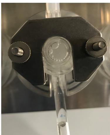
**Abb. 5.1.:** Abgebildet ist eine FRANZ-Zelle während eines Diffusionsexperiments. Durch Verdunsten des Akzeptormediums kam es zur Bildung von Luftblasen unter der Membran, die die Diffusionsfläche verringerten.
