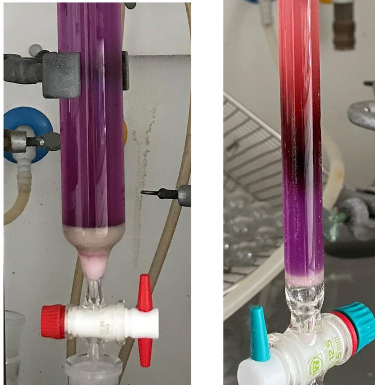
**Abb. 4.5.:** **Links:** Nach erfolgter säulenchromatographischer Trennung verblieb vermutlich ein Teil des Naphthazarins auf dem Kieselgel der Säule, was an der starken Violettfärbung erkennbar ist. **Rechts:** Nach Versetzen des Fließmittels mit wenigen Millilitern Ameisensäure verfärbte sich das violette Kieselgel wieder rötlich und es wurde eine weitere unsaubere Fraktion erhalten.
