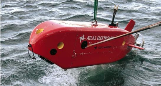
Moderne Sonartechnik und künstliche Intelligenz zeichnen das autonom agierende Unterwasserfahrzeug IMGAM aus. Es kann Gasaustritte am Meeresboden detektieren, sich eigenständig darüber positionieren und das aufsteigende Gas beproben oder aber mithilfe der neuen Sensoren direkt analysieren.
