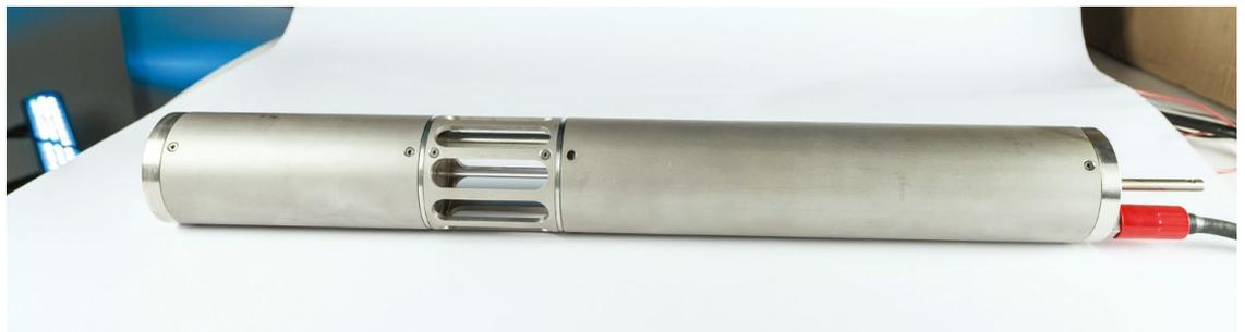
*Diese Bilder zeigen den neuen optischen CO<sub>2</sub>-Sensor, der am Fraunhofer-Institut für Physikalische Messtechnik in Freiburg entwickelt wurde. Er kann sowohl auf Meeresbodenstationen eingesetzt werden als auch im weiterentwickelten Unterwasserfahrzeug IMGAM.*
