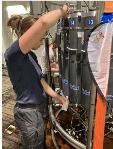
*Abb.2b: Abfüllen der Wasserproben aus den unterschiedlichen Tiefen aus den jeweiligen Niskin-Flaschen.*
