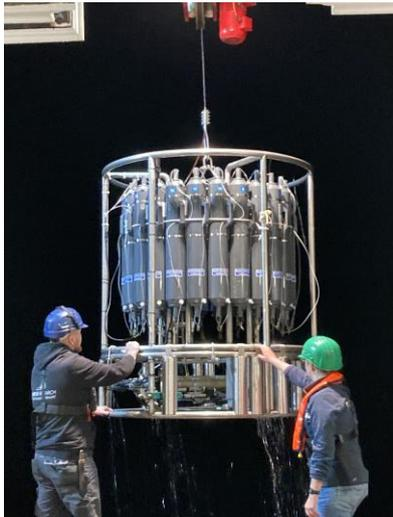
*Abb.2a: Die CTD-Sonde mit Kranzwasserschöpfer kommt zurück an Deck. Schiffscrew (links) und Wissenschaft (rechts) arbeiten Hand in Hand. Alle Fotos: J.G.*
