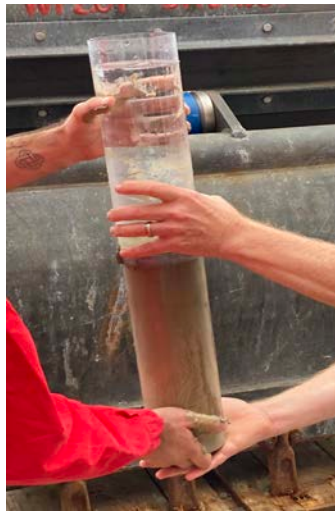
Abb.1b: Sorgfältig werden die Rohre mit den ausgestochenen Sedimenten geborgen. Die obersten 30 cm sind noch mit dem original Bodenwasser aus mehreren tausend Metern Tiefe gefüllt. Foto J.G.
