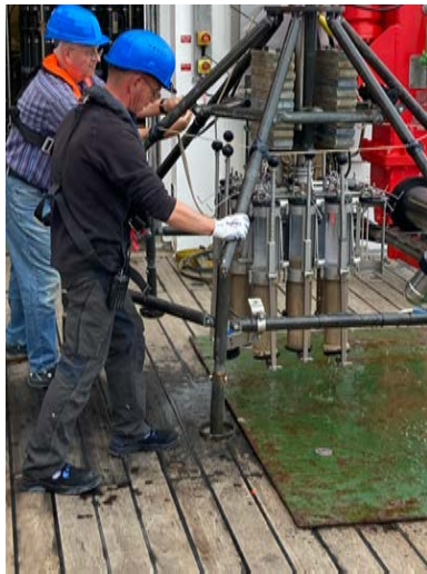
Abb.1a: Ein erfolgreich mit Tiefsee-Sediment befüllter MUC kommt zurück an Bord. Wissenschaft (links) und Schiffscrew (rechts) arbeiten Hand in Hand. Foto: J.G.
