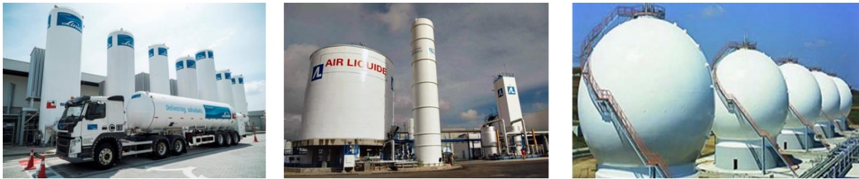
Abbildung 31: Tanktypen für LCO 2 (Quellen: Linde, Air Liquide)
