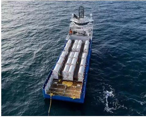
Abbildung 27: Transport begrenzter Mengen LCO 2 per Tankcontainer mit Schiffen (Quelle: gas.info)
