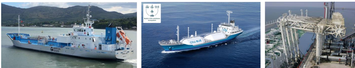
Abbildung 26: LCO 2 Tankschiffe und Marine Loading Arms für große Volumen (Quellen: MHI, SVT)
