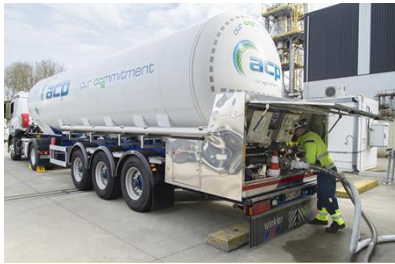
Abbildung 25: Starre und flexible Entladeleitungen im Einsatz am TKW (Fa. ACP)
