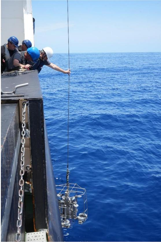
Abb. 3: Mini MUC am Kran hängend, vor der Befestigung am CTD-Rahmen. Foto E. Achterberg.
