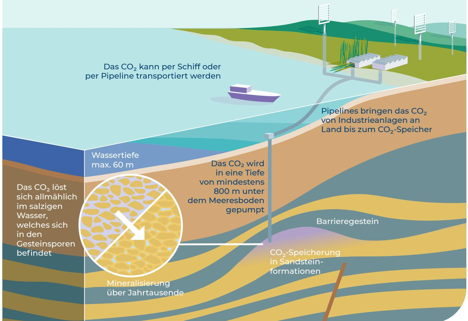
Für die Speicherung im tiefen Meeresuntergrund wird flüssiges Kohlendioxid durch eine Pipeline oder aber per Schiff in das entsprechende Meeresgebiet transportiert und durch eine oder mehrere Bohrungen in tiefliegende poröse Sandsteinformationen gepresst.
