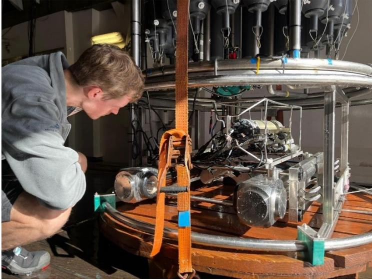
Abb. 3. Tobias inspiziert das Kamerasystem Plankton Imaging and Scanning Optics (PISCO), das an der CTD-Rosette (Conductivity Temperature Depth)
