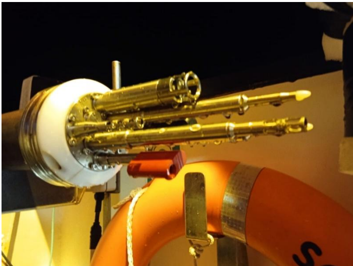
Abb. 4. Sensoren an der Spitze des Mikrostrukturprofilers. Foto von Hannah Melzer.
