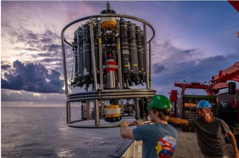
Profiler), um die Strömungen bis zum Meeresboden zu erfassen. Außerdem haben wir an der CTD einen Kranz von Wasserschöpfern, mit denen wir Wasserproben aus verschiedenen Tiefen holen können. Diese werden dann größtenteils bereits an Bord im Labor analysiert. Zum einen wird der Salzgehalt mit einem Salinometer gemessen und zum anderen wird die Sauerstoffkonzentration der Wasserproben
