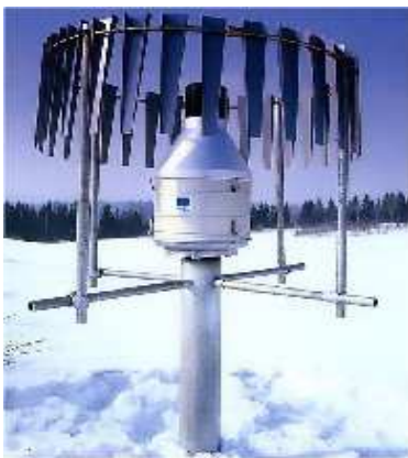
Abbildung 5.1: Geonor-Niederschlagsmessgerät mit einfachem Windschutz (GEONOR-Inc (2006))
