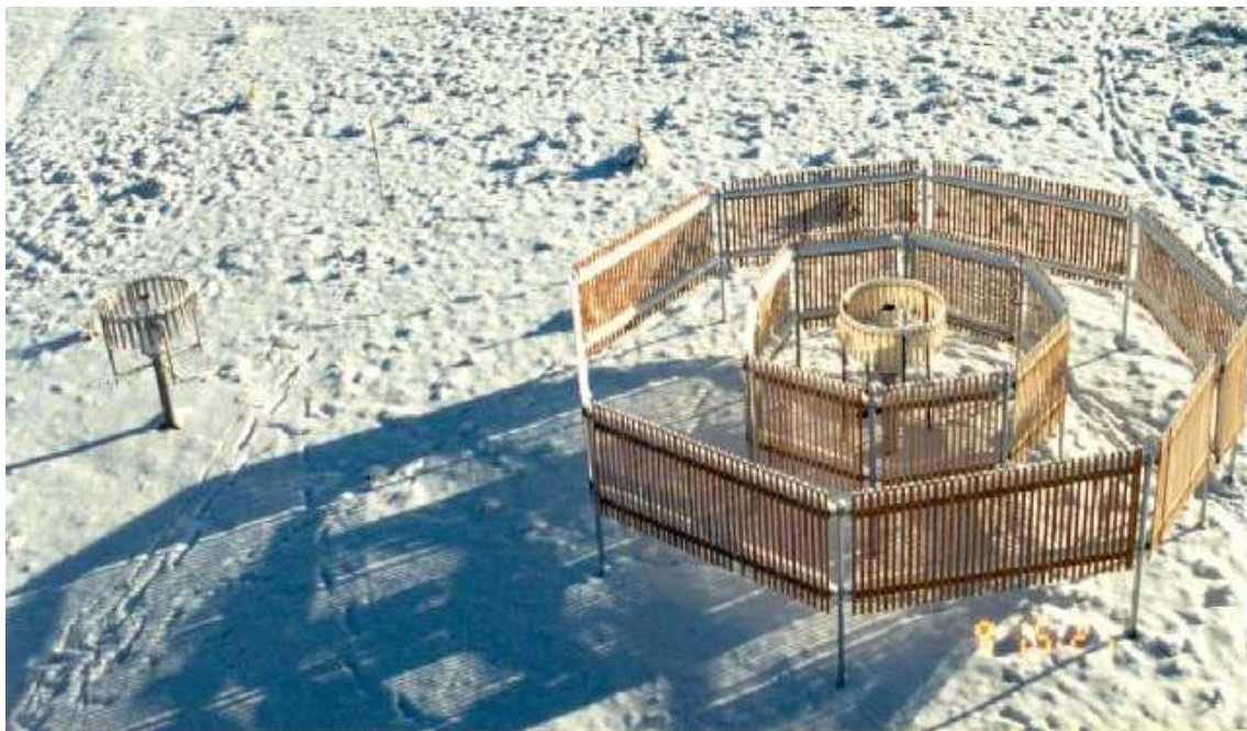
Abbildung 5.2: Geonor mit einfachem Windschutz (links) und mit DFIR-Windschutz (rechts) Cole (2006).
