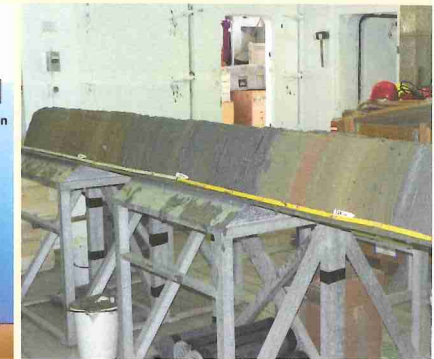
Sedimentkern aus dem Arktischen Ozean. Die Farbwechsel der einzelnen Schichten sind Hinweise auf Umweltveränderungen (z.B. Meereisbedeckung) in der geologischen Vergangenheit.
