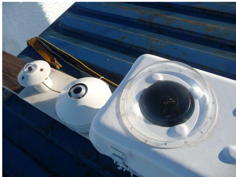
**Abbildung 4.2:** Pyranometer (links), Pyrgeometer (Mitte) und Vollhimmelskamera (rechts)
