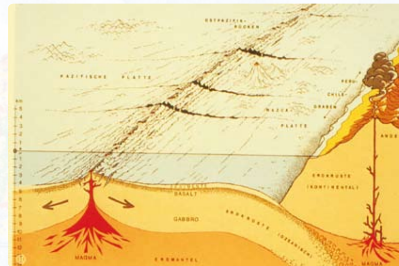
Abb.3: Schema der Bildung und Wiederaufschmelzung von ozeanischer Kruste. Die im Zentrum von langgestreckten submarinen Gebirgszügen durch das Aufdringen und Erstarren magmatischer Schmelzen neu entstehende ozeanische Kruste wird mit Geschwindigkeiten von bis zu 10 cm/Jahr vom Ort der Entstehung wegtransportiert. In so genannten Subduktionszonen wird die dann schon einige Millionen Jahre alte, kalte und damit schwere Kruste unter den Rand der Kontinente geschoben und hier aufgeschmolzen. Dieser Prozess ist zum Beispiel die Ursache für den Vulkanismus in den Anden.
