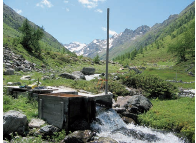
Messung von Wasserstand, elektrischer Leitfähigkeit und Wassertemperatur an den Lareinsonntagspleisquellen
