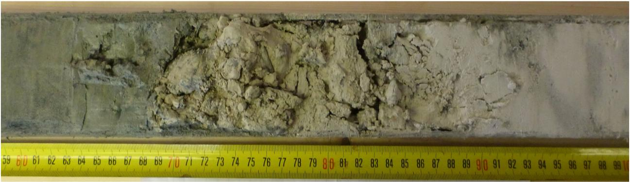
Bild 2: Der Übergang von glaukonitisch-sandigen Tonen zu Kreidelagen in 70 cm Sedimenttiefe. Der verfestigte Horizont deutet auf eine Ablagerungsdiskontinuität.
