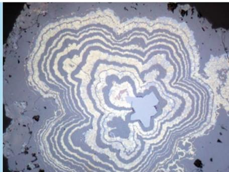
Viele Massivsulfide zeigen auch in mikroskopischen Aufnahmen Hinweise für einen Zonarbau, der Jahresringen im Holz gleicht. In dem Beispiel links wechseln die physikochemischen Eigenschaften der heißen Lösungen sehr schnell und bilden Wechsellagerungen aus Zinksulfiden [ $\text{ZnS}$ , mittelgrau] und Kupfersulfiden [ $\text{CuFeS}_2$ , gelb, hellgrau, braun]. Bildbreite: 0,03 mm.
