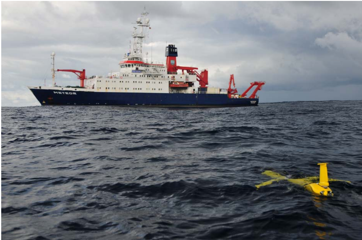
Abb. 3: Gleiter „Deepy“ vor der Aufnahme nach seiner eintägigen Mission mit der Mikrostruktursonde im Huckepack.
