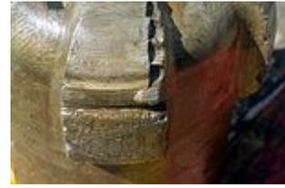
Die Materialbelastung bei tiefen Bohrungen ist enorm: Ein ausgebissener Bohrkopf.
