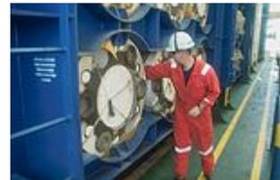
Diese Riser-Pipes verschließen das Bohrloch am Meeresboden und ermöglichen deshalb tiefe Bohrungen ohne die Gefahr von Blow-outs.
