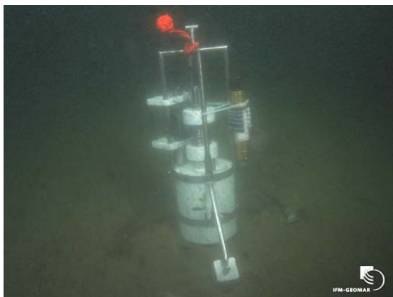
Der Porenwassersammler (PWS) im Einsatz. Foto: Peter Linke, IFM-GEOMAR
