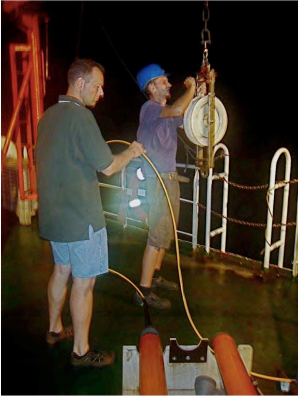
Abb. 2: Aussetzen der Magnetometersensoren bei Nacht.
