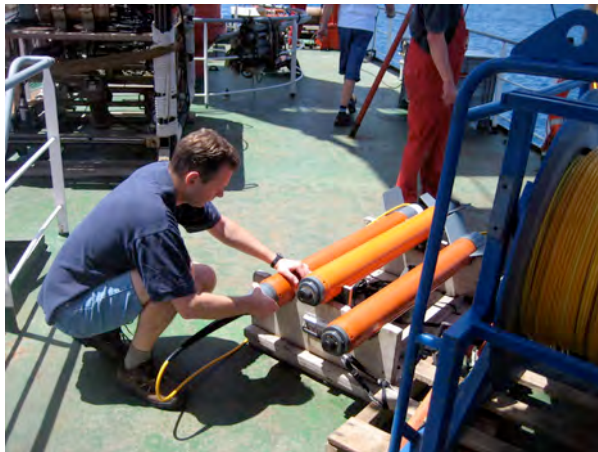
Anschließen der Kabel an die Magnetometer-sensoren.
