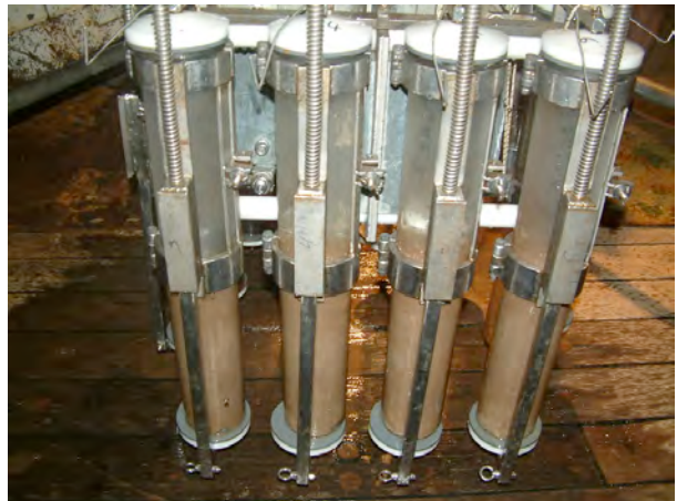
Proben der Sedimentoberfläche des Argobeckens, die mit dem Multicorer aus gut 5.700 m Tiefe gewonnen wurden.
