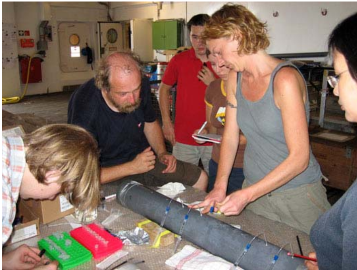
Beprobung der Sedimentkerne auf Porenwasser
