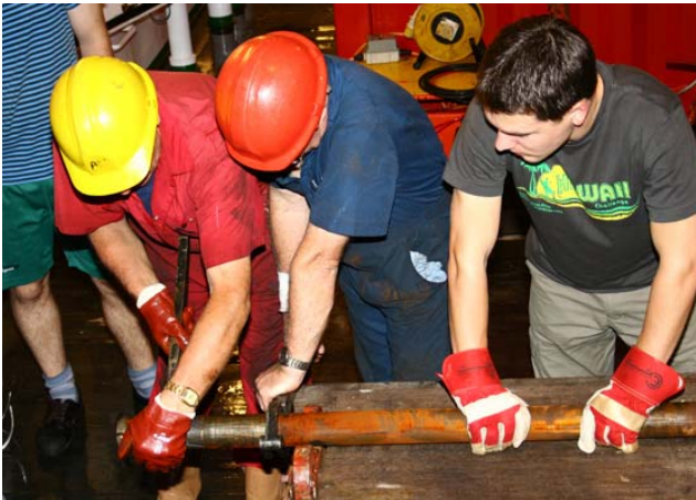
Öffnen eines Rockdrill 2 Kerns
