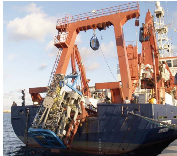
Abb. 7: Schemazeichnung des MeBo-Systems mit ausgeklappten Beinen auf dem Meeresboden (links); MeBo beim Ausbringen von FS METEOR (rechts).
