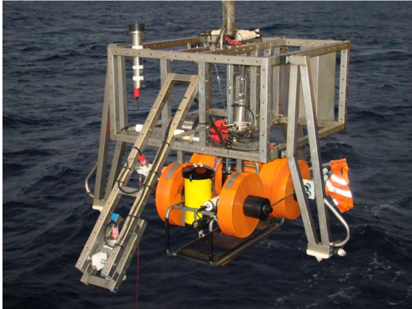
Abb 16: Lander-System zur Messung physikalischer, chemischer und biologischer Parameter im Bodenwasser.
