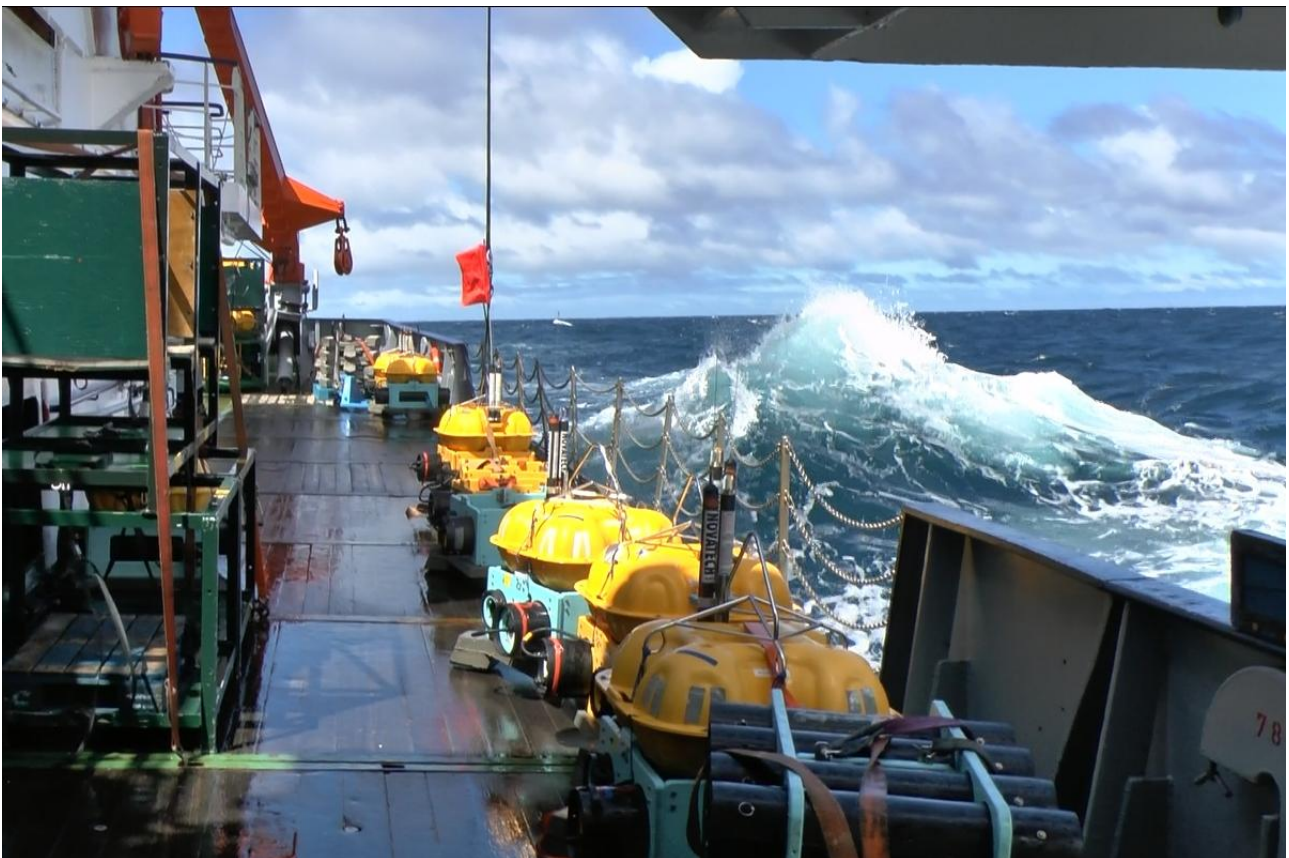
Die Ozeanboden-Seismometer stehen vorbereitet an Deck und sind klar zum Aussetzen.
