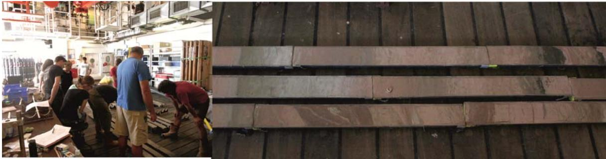
Abb 3: Intensive Diskussion der Kerne (links) die den Übergang von einem Schuttstrom (unten rechts) über leicht deformierte Sedimente (oben rechts) zu ungestörten Hintergrund-Sedimenten zeigen (mitte rechts). Photos: Heiko Jähmlich und Russell Wynn.
