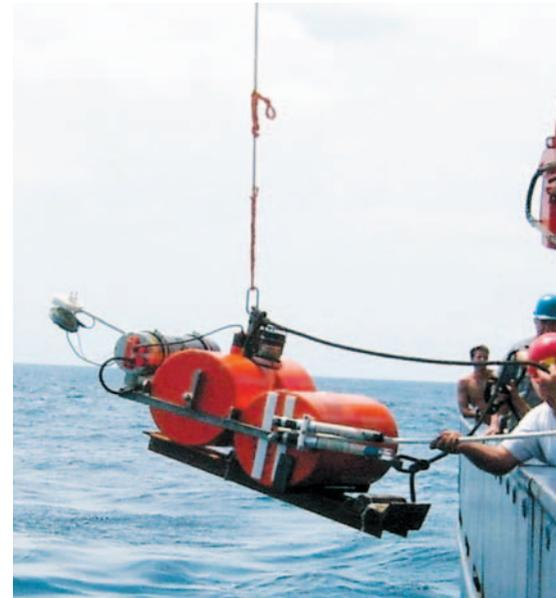
Ein von IFM-GEOMAR entwickeltes Ozeanboden-Seismometer (OBS) zur Messung von seismischen Wellen
