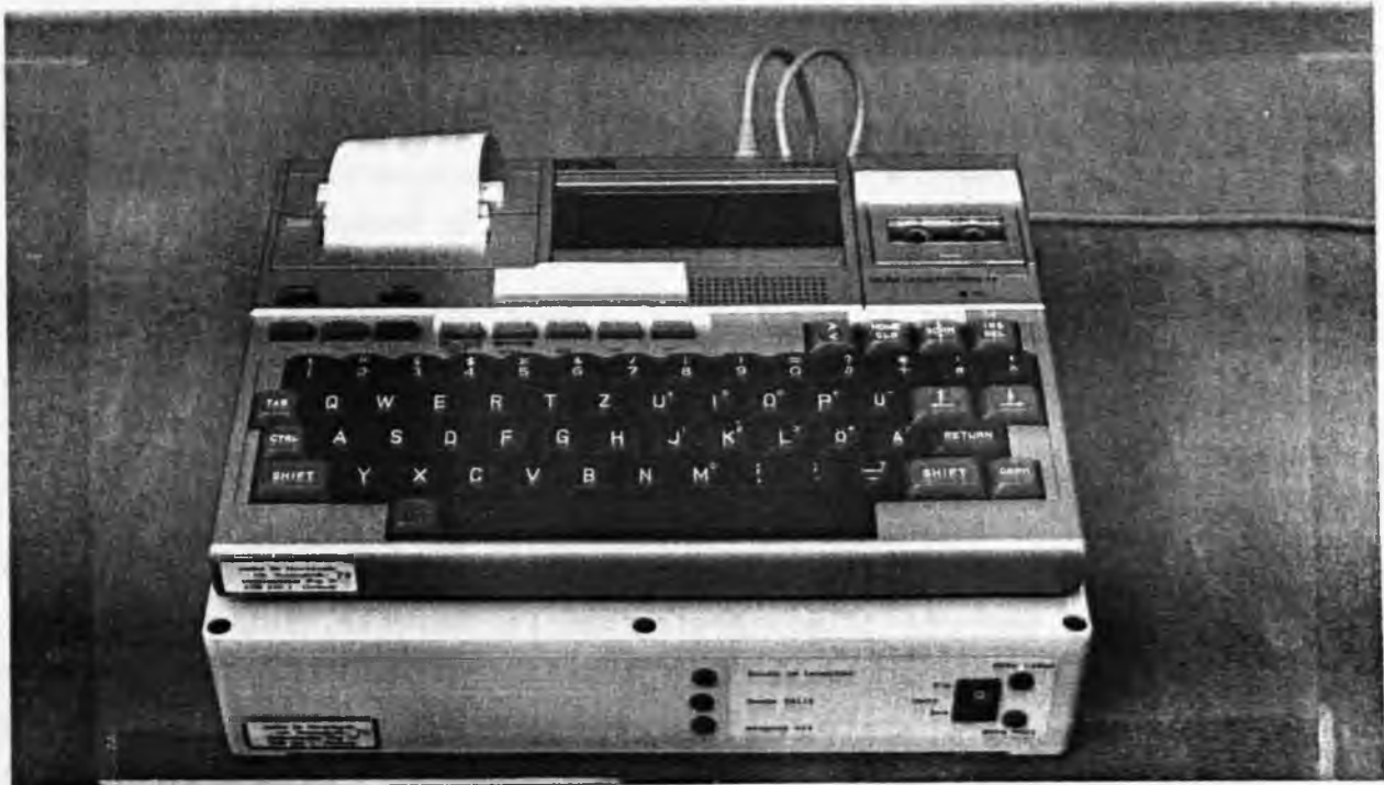
Abb. 6: XBT-Datenerfassung mit Controller (weiß) und aufgesetztem Epson HX20-Rechner. Das Netzteil für den Rechner befindet sich in der Controllerbox. Die Datenausgabe erfolgt auf Papierstreifen (l) und Minikassette (r). Zur Kontrolle der Messung steht eine Anzeige (Mitte) zur Verfügung. Die Anlage erfüllt dieselbe Funktion wie das in Abb. 5 dargestellte Vorläufermodell. Maße: Länge 30 cm, Tiefe 23 cm, Höhe 12 cm.
