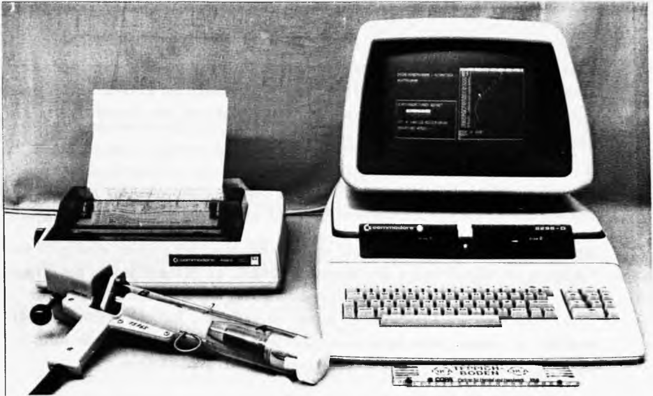
Abb. 5: XBT-Datenerfassung mit Commodore 8296D (rechts), Drucker (links hinten) und Handabwurfgeräte (links vorn), in das eine Demonstrationssonde eingelegt ist. Der abgebildete Rechner ersetzt den Vorläufer 8032SK, bei dem noch ein Diskettenlaufwerk gleicher Grundfläche erforderlich war.
