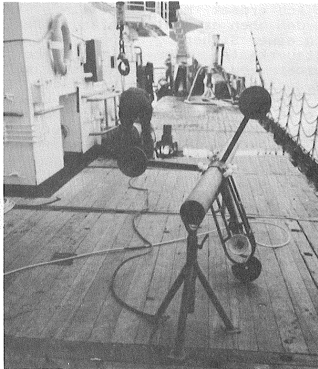
Abb. 5. Gestell mit Videokamera und Scheinwerfer für die video-gesteuerte Kernentnahme mit dem Schwerelot.
