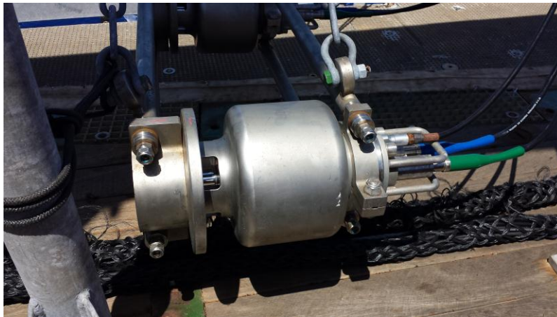
Abbildung 2: 4-Liter-Luftkanone zur Erzeugung seismischer Signale. Die Luft wird auf 190 bar verdichtet und explosionsartig freigegeben. Auf der Reise M115 werden insgesamt 12 solcher oder ähnlicher Kanonen zu einem Verbund an Kanonen zusammengeschaltet, so dass wir insgesamt 86-Liter an komprimierter Luft als Schallquelle nutzen können.
