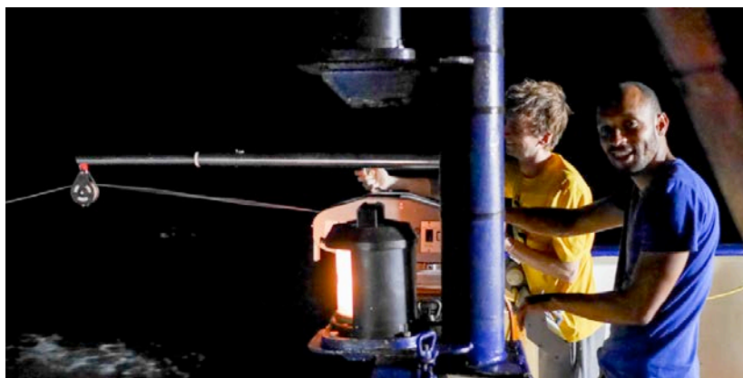
Die U-CTD wird mit der Winde am Heck wieder eingeholt.
