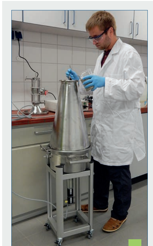
Alexander Hentzsch beim Bearbeiten einer Sedimentprobe in einem Mikroplastik Sediment Separator. / Alexander Hentzsch processing a sediment sample in a MicroPlastic Sediment Separator. (Foto / Source: IOW)
