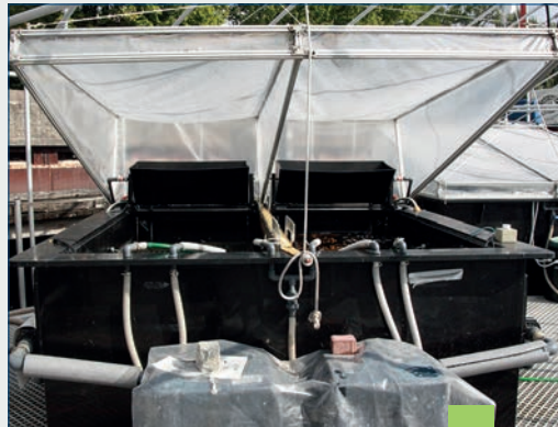
Abb. 1. Experimenteller Benthokosmos am GEOMAR in Kiel und der in den Experimenten eingesetzte Blasen-tang Fucus vesiculosus . / Fig. 1. Experimental benthocosm at the GEOMAR in Kiel and Fucus vesiculosus applied in the set-ups. (Foto / Source: IOW)
