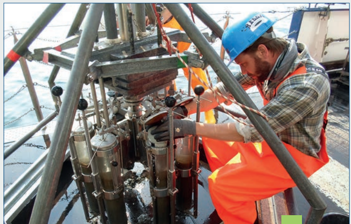
Sascha Plewe entnimmt für das SECOS Projekt Sedimentkerne aus 19 m Wassertiefe auf der Station Stoltera, Mecklenburger Bucht. / Sascha Plewe taking sediment cores for the SECOS project from 19 m water depths at Stoltera, Mecklenburg Bight. (Foto / Source: IOW)
