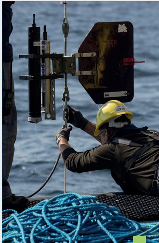
Ausbringen von hochauflösenden verankerten Strömungsmessern zur Turbulenzmessung auf dem FS ELISABETH-MANN-BORGESE (EMBo68) . / Deployment of moored high resolution flow meters for measurement of turbulences at RV ELISABETH-MANN-BORGESE (EMBo68) . (Foto / Source: IOW)
