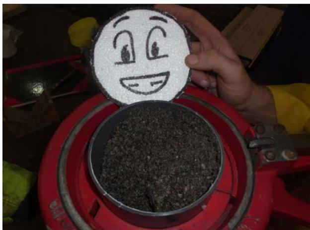
Abb. 4: Kiese im Liner eines Schwerelotes.
