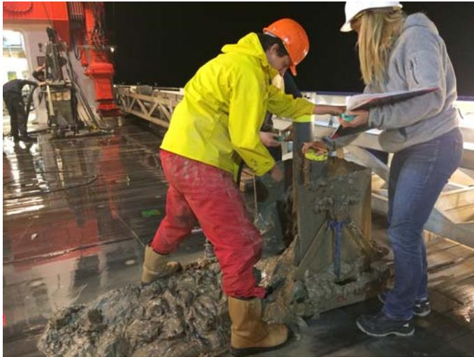
Abb. 3: Großkastengreifer mit Ablagerungen der Turbidites von 1929. Photo: Aggeliki Georgiopoulou
